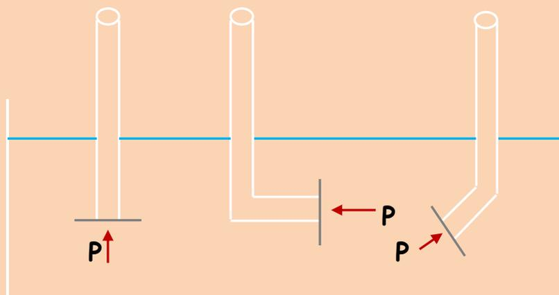
Según la experiencia las laminillas metálicas no son desplazadas por la presión ( $P$ ) que se ejercen sobre ellas y en los tubos de vidrio no entra líquido del recipiente. Podemos concluir: **la presión ejercida en el interior de un líquido actúa en todas las direcciones y sentidos y siempre perpendicularmente a la superficie del cuerpo.**
