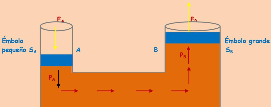
La aplicación práctica consiste en poner un cuerpo en el émbolo B para elevarlo a la altura que deseemos. En esquema clarificador lo tenemos en el siguiente dibujo:
