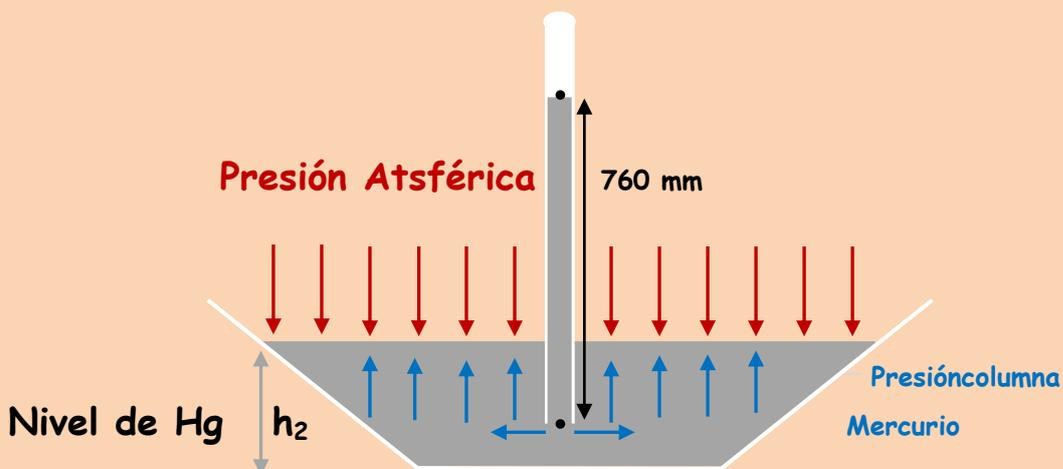
Observó que la altura de Mercurio el tubo descendía un poco mientras que el nivel del mercurio en la cubeta aumentaba. El sistema se estabilizaba cuando la presión ejercida por el Mercurio es compensada por la presión atmosférica.
