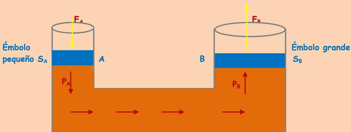
Al ejercer una fuerza exterior  $F_A$  sobre el émbolo pequeño (izquierda) de sección  $S_A$  creamos una presión  $P_A$  que se transmite con igual intensidad en todas las direcciones de la prensa (aceite) llegando al émbolo grande (derecha) transformándose en una presión  $P_B$  (de igual intensidad a  $P_A$ ) que al actuar sobre la sección  $S_B$  se crea una fuerza  $F_B$  que hace posible que el émbolo grande se **eleve**.
