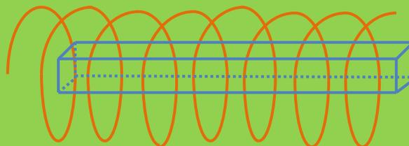
El tipo más simple de *electroimán* es un trozo de alambre enrollado. Una **bobina** con forma de tubo recto se llama solenoide. Pueden producirse campos magnéticos mucho más fuertes si se sitúa un “núcleo” de material *paramagnético* ( Se denomina materiales paramagnéticos a los materiales o medios cuya “*permeabilidad magnética* es similar a la del vacío) o de materiales ferromagnéticos (normalmente “hierro dulce”).
