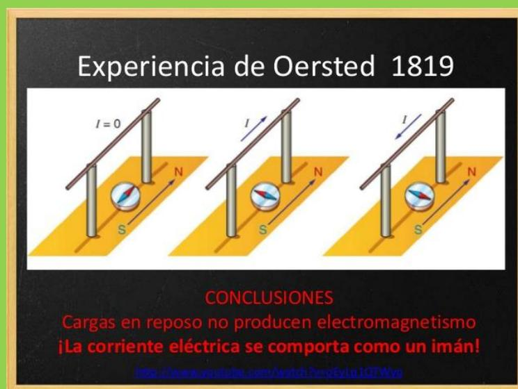
Oersted experimentaba moviendo la brújula cerca del cable que conducía la corriente eléctrica y observó que la aguja imantada de la brújula giraba hasta quedar en posición perpendicular a la dirección del cable.
