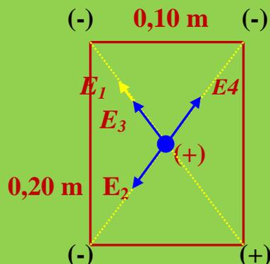
$$E_1 = K \cdot q_1/R_1^2 = 9 \cdot 10^9 \text{ N} \cdot \text{m}^2/\text{C}^2 \cdot 1,5 \cdot 10^{-6} \text{ C} / (0,11 \text{ m})^2 = 1125 \cdot 10^3 \text{ N/C}$$
