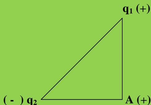
Al existir dos cargas,  $q_1$  y  $q_2$ , en el punto A se generarán dos campos parciales. Geométricamente y suponiendo la unidad de carga eléctrica positiva en el punto A:
