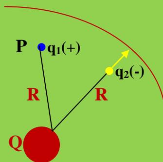
$$\begin{aligned} a) E &= F / q_1 ; E = 0,06 \text{ N} / 0,3 \cdot 10^{-6} \text{ C} = 0,2 \cdot 10^6 \text{ N/C} = \\ &= 2 \cdot 10^5 \text{ N/C} \end{aligned}$$
