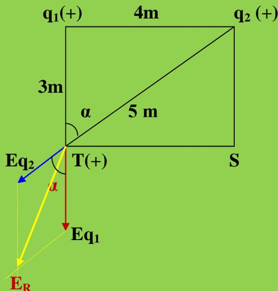
En el vértice T existirán dos campos eléctricos debido a la existencia de \$q\_1\$ y \$q\_2\$. Supondremos en T existe la unidad de carga positiva (+). Por Pitágoras la distancia entre \$q\_2\$ y T vale **5 m**.
