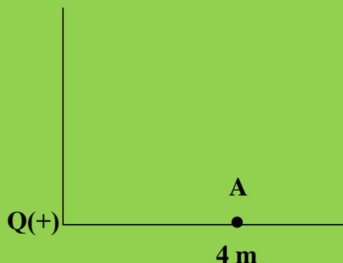
$$\begin{aligned} \text{a) } V &= K \cdot Q / R ; V = 9 \cdot 10^9 \text{ N} \cdot \text{m}^2/\text{C}^2 \cdot 2 \cdot 10^{-6} \text{ C} / 4 \text{ m} = \\ &= 4,5 \cdot 10^3 \text{ J/C} = 4,5 \cdot 10^3 \text{ V} \end{aligned}$$
