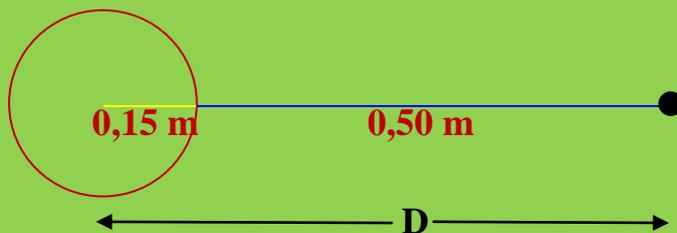
$$V = K \cdot Q / D ; D = 0,15 \text{ m} + 0,50 \text{ m} = 0,65 \text{ m}$$
