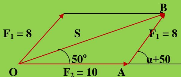
En el triángulo  $\widehat{OAB}$  de la figura anterior y por el teorema del coseno:
