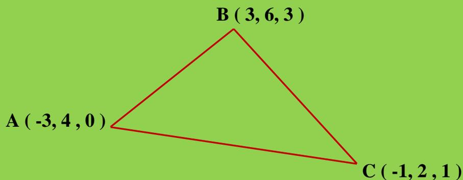
Calcularemos los vectores correspondientes a cada uno de los lados del triángulo, sus módulos y aplicando el teorema del coseno, los cosenos de los tres ángulos del triángulo:
