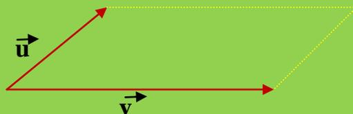
$$\text{Área del paralelogramo} = |\vec{u} \times \vec{v}|$$
