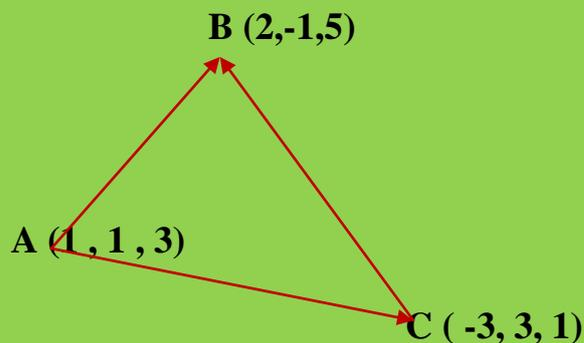
$$\text{Área del triángulo} = \frac{1}{2} | \vec{AB} \times \vec{AC} |$$
