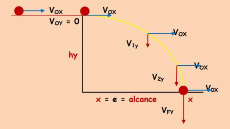
Al actuar la "gravedad" la componente Vy aumenta a medida que se produce el movimiento.
