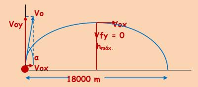
En el punto de máxima altura sólo existe componente Vox de la velocidad. La componente Vy es nula.
