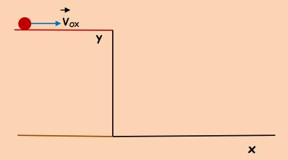
En esta situación no existe la componente  $\overrightarrow{V}y$  de la velocidad. Cuando el cuerpo llega al vacío permanecerá la  $\overrightarrow{V}_{OX}$  (que permanece constante ya que no existe fuerza que aumente o disminuya la velocidad) y aparecerá la componente  $\overrightarrow{V}y$  por la acción de la gravedad haciendo posible que la trayectoria seguida por el cuerpo sea de tipo parabólico:
