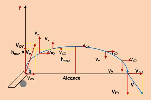
El cañón dispara el proyectil con una velocidad inicial Vo. Esta velocidad es rápidamente descompuesta en sus dos componentes  $V_{OX}$  y  $V_{OY}$ . A partir de este momento el
